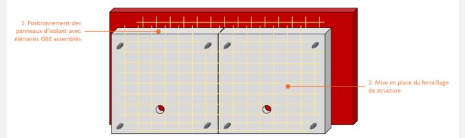
Astuce : La mise en place de quelques connecteurs intérieurs (voir étape suivante) avant la mise en place des aciers et treillis soudés permet d'assurer facilement la tenue de ce ferraillage.
